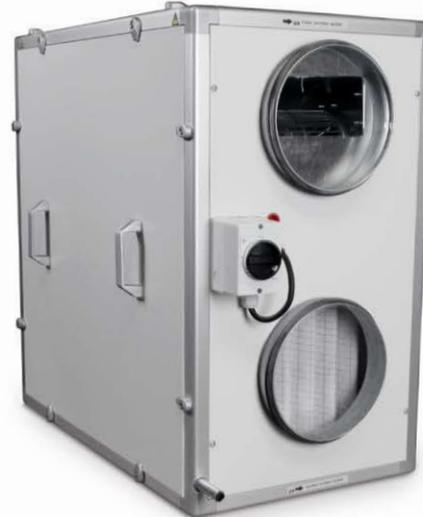
Die Serie **EcoCompact MT** und **M** wurde für eine kontrollierte mechanische Lüftung mit Wärmerückgewinnung für Volumenströme bis 1.200 m<sup>3</sup>/h entwickelt und verfügt über Radialventilatoren, die mit energiesparenden EC-Antriebsmotoren ausgestattet sind. Weiterhin sind ein 100%-Bypass zur Umgehung des ALU-Gegenstromplattentauschers und eine Kondensatwanne aus nicht rostendem Material eingebaut. Ebenso sind Luftfilter der Klassen G4 bis F7 vorgesehen.
